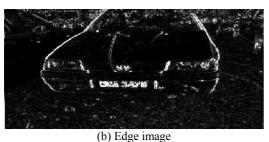
Figure 4. Sobel edge detection.
